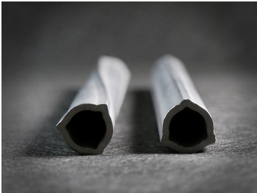
Abbildung 4 stark verdrilltes und begradigtes Rohr (Symbolbild)
