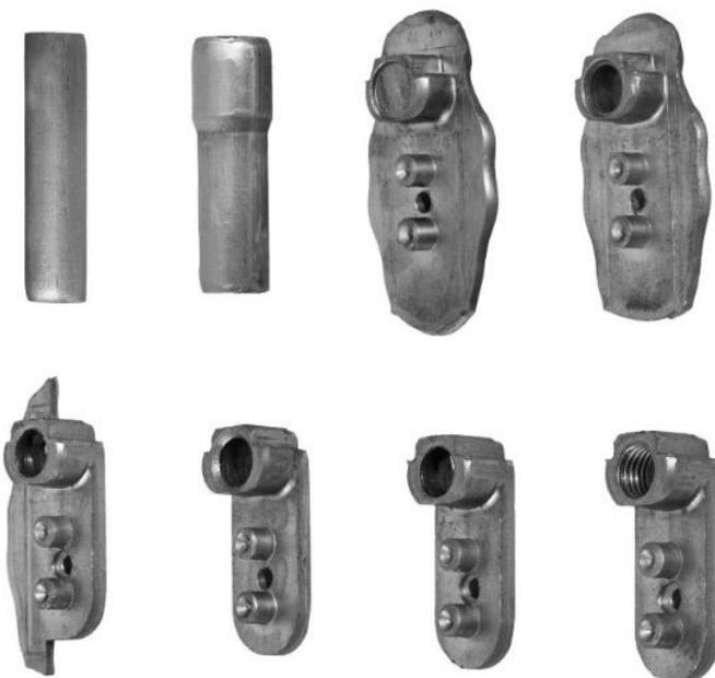
**Möbelverbinder - 8 Prozessstufen bei der Kaltumformung aus Draht**
