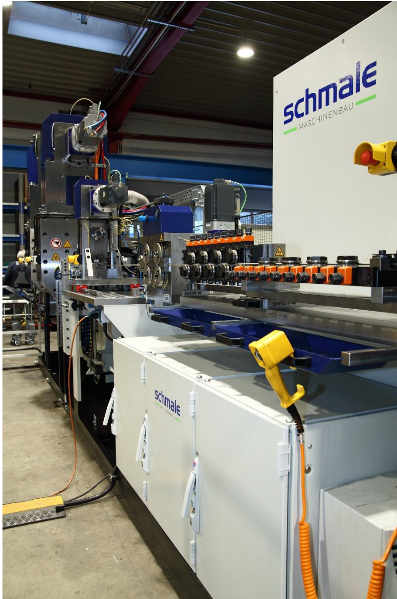
Gesamtansicht der Anlage zur Fertigung von Holzbauschrauben (Fotoinweis: Schmale Maschinenbau GmbH)
