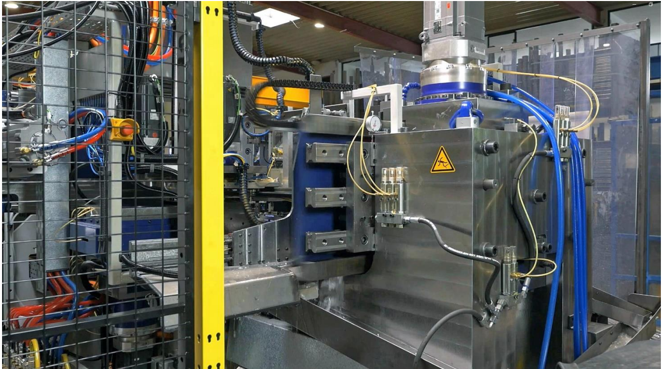
Gewindewalzeinheit (Fotoinweis: Schmale Maschinenbau GmbH)
