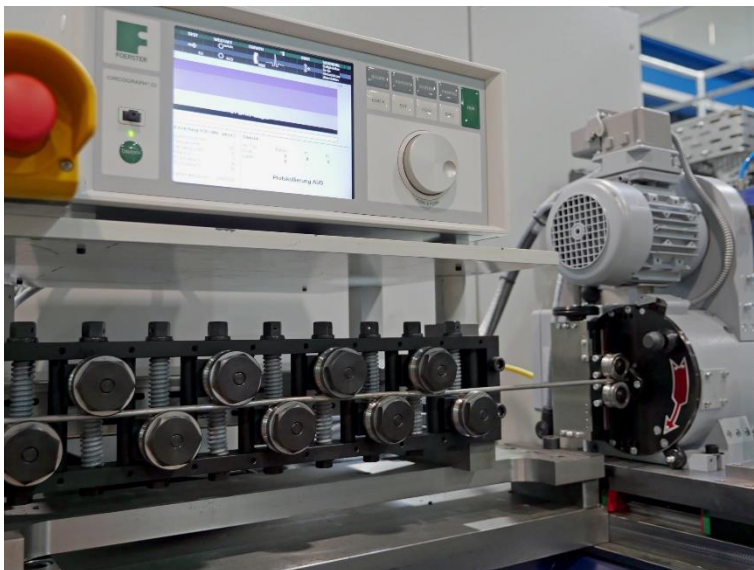
Abbildung 4 Wirbelstromprüfung der Drahtoberfläche
