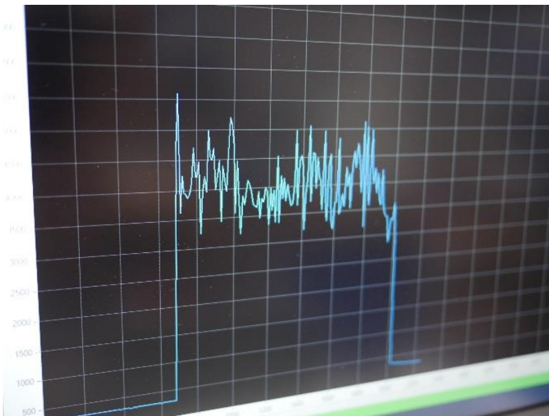
Abbildung 2 Lichtspektrum Laserschweißung (Fotoinweis: Schmale Maschinenbau)
