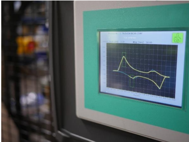
Abbildung 3 Kraft-Weg Messung beim Kalibrieren (Fotoinweis: Schmale Maschinenbau)
