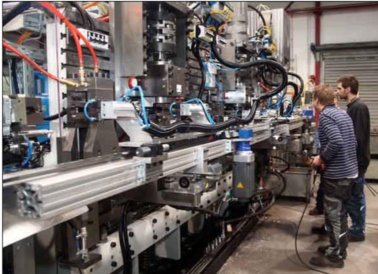
Präzise und leistungsfähig: Neue Schmale-Anlagen werden ausschließlich mit servoelektrisch angetriebenen Lineartransfersystemen ausgestattet. (Fotoinweis: Schmale Maschinenbau)
