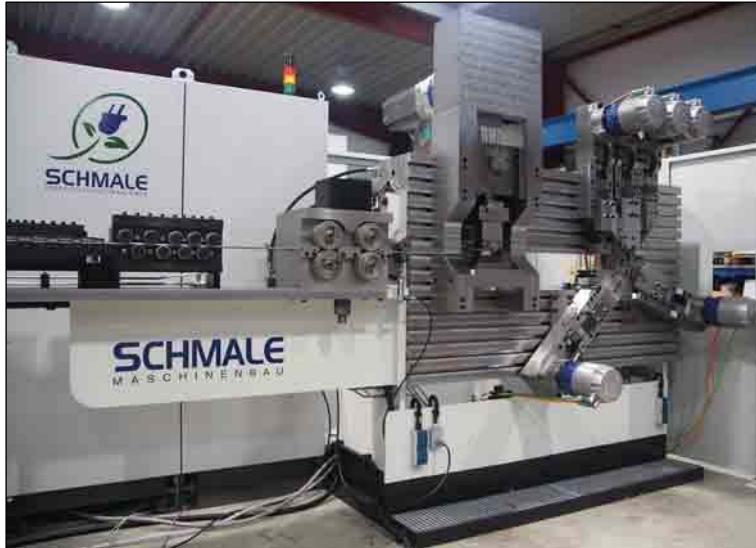
Meilenstein der Servotechnik: Vor gut zwei Jahren präsentierte Schmale die erste vollständig servoelektrisch angetriebene Maschine des Typs X2000NC. (Fotoinweis: Schmale Maschinenbau)
