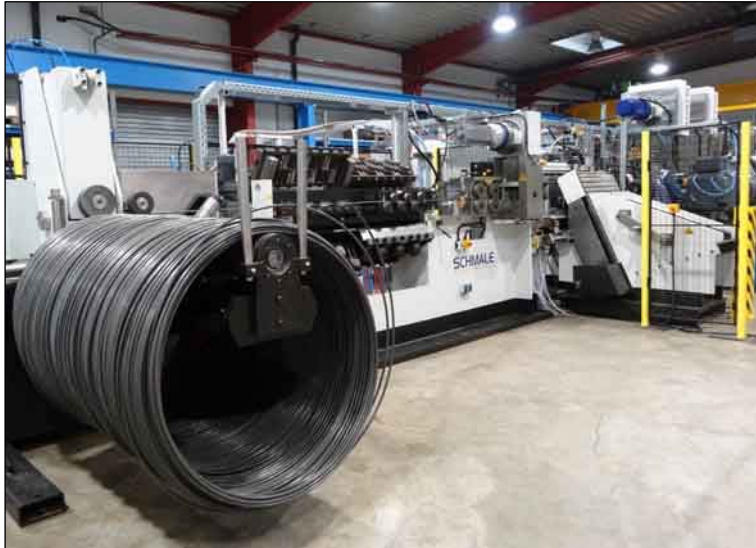
Taktleistungsgeführter Horizontal-Haspel, Sechsfach-Revolver-Richtwerk und Bunkerförderer: Die Materialzuführung kann mit Highlights aufwarten. (Fotoinweis: Schmale Maschinenbau)
