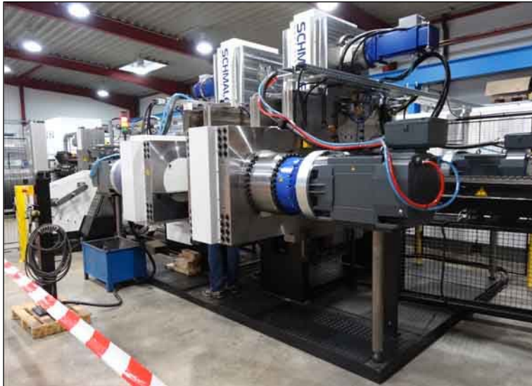
Meilenstein der Pressentechnik: Die 300-Tonnen-Doppelstauchpresse der Schmale-Anlage markiert einen neuen Spitzenbereich.
