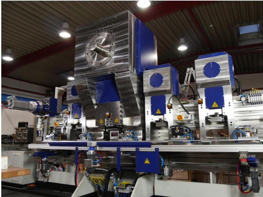
X2000NC mit 7000kN Presse und vier weiteren Stationen (Fotoinweis: Schmale Maschinenbau)
