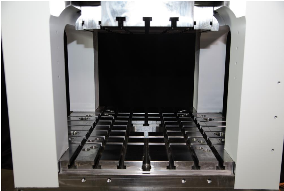
Der große Werkzeug Einbauraum mit T-Nuten und 600 x 470mm Abmessung (Fotoinweis: Schmale Maschinenbau)
